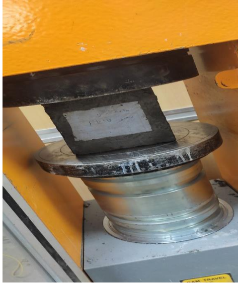
الشكل (٥) مكعب اختبار مقاومة الخرسانة للضغط
